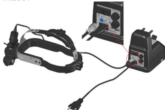
Conectar a Unidade de Observação ao Módulo de Controle, utilizando o conector Amphenol 3 pinos.
