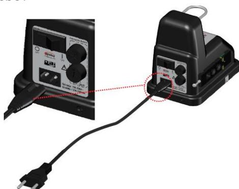
Conectar o Cabo de Alimentação ao Módulo de Controle, utilizando o conector Tipo 8.
