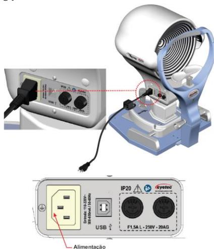
Conectar o Cabo de Alimentação à Unidade de Observação, utilizando o conector IEC 3 pinos.
