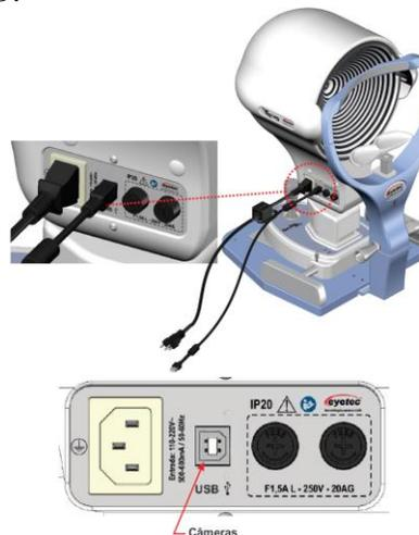
Conectar o Cabo das Câmeras à Unidade de Observação, utilizando os conectores USB.
